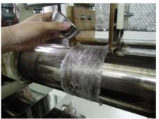
Step2: 清理與收集盤內,將剩餘掉落的助劑加入滾動的混練膠中。
