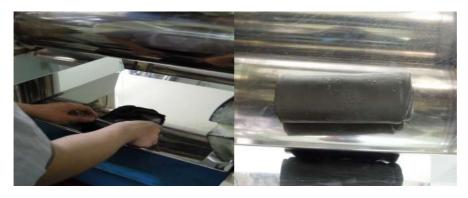
Step2: 將混煉膠從滾輪移出。
