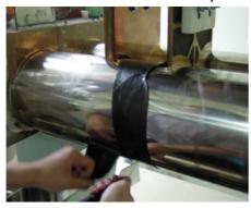
Step2: 切下右側膠料,拉出部分膠料,再放入滾筒中。
