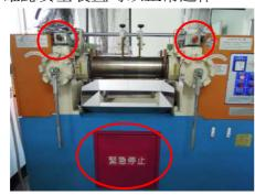
2. 測量滾筒的表面溫度。
