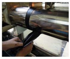
Step5: 重複左右側切混煉膠,拔出部分後再放入滾輪中,重複四次。
