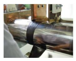
Step3: 重複切下左、右側膠料,拉出部分膠料,再放入滾筒中,共四次。
