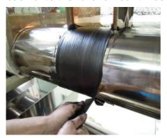
※ 確認所有助劑都完全分散均匀(膠料表面需平整,並且沒有顆粒在表面上)
