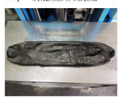
Step3: 切開混煉膠,確認切面是否有藥品顆粒,如果混練膠仍有顆粒在其中,折成三角包與滾筒包重新混練,直到混練均勻後再移開滾輪。
