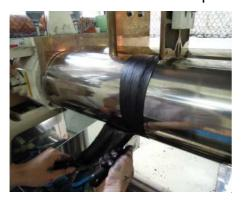
Step4:切下右側膠料一次,拉出部分膠料,再放入滾筒中。
