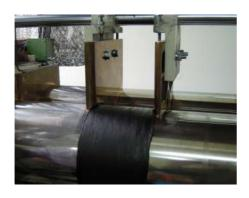
Step2: 將加硫劑、加硫助劑、延遲劑,加入滾動中的膠料中。 Add curing agents into the compound.
